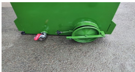
Vanne de vidange et trou d'homme pour nettoyage
