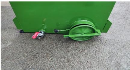
Valvola di scarico e pozzetto per la pulizia
