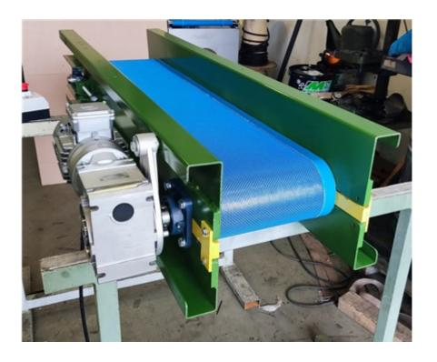
Diseñado para recuperar los residuos permitiendo el paso del agua, este tipo de transportador se coloca al final de un transportador de residuos para drenar el agua de los residuos
