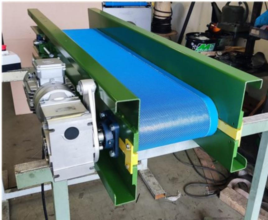
Progettato per recuperare i rifiuti consentendo il passaggio dell'acqua, questo tipo di trasportatore è posizionato all'estremità di un trasportatore di rifiuti per drenare l'acqua dai rifiuti
