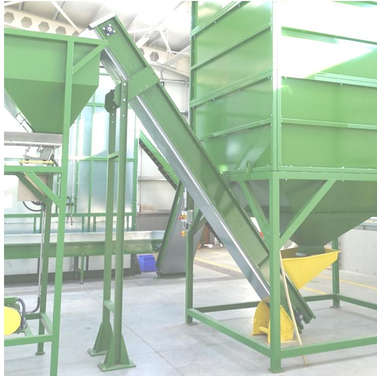
Ces convoyeurs et élévateurs sont destinés à des débits plus importants que les élévateurs en auge et ont une conception permettant d'utiliser des tapis plus larges
