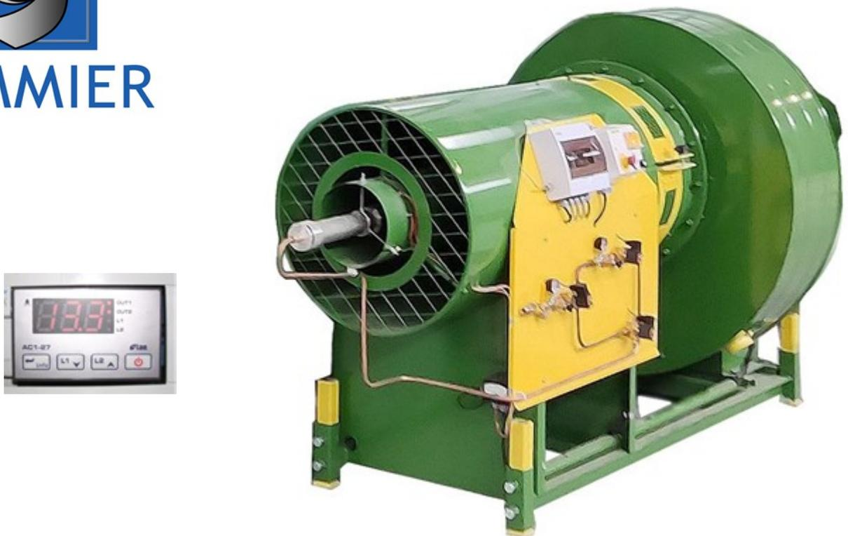
Ideales para torres de secado, estos generadores, que son más silenciosos que los generadores axiales, permiten que una presión suficientemente alta pase a través de varios metros de producto
