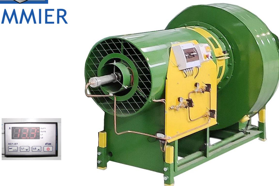
Ideals pour les tours de séchage, ces générateurs, plus silencieux que les générateurs axiaux permettent d'obtenir une pression suffisamment importante pour traverser plusieurs mètres de produit
